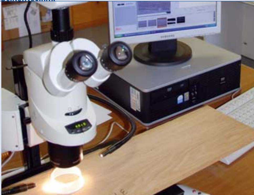
Maximale Prozessoptimierung im Fokus: Im Vorführzentrum in Schio setzt Costa ein spezielles, computerunterstütztes System für die mikroskopische Analyse der Oberflächengüte ein
