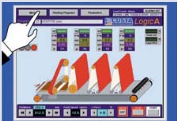
PC-Steuerung Costa LogicA: Sie ermöglicht es, die Maschine sehr komfortabel auf die entsprechende Anwendung einzustellen
